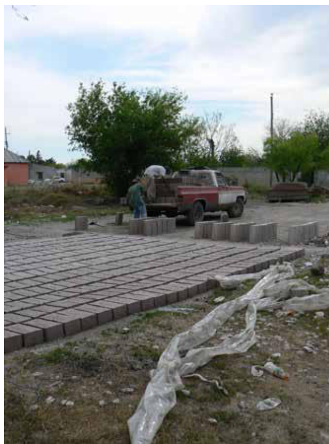
Figura 7. El aprovechamiento de ceniza, resultante del horneado de carbón para obtención de coque, es un asunto documentado desde al menos 1890. En la actualidad muchas personas, en periodos en que no tienen ingresos o trabajo, se dedican a fabricar ladrillos de “cal y ceniza”, y así sortean periodos de escasez únicamente con su trabajo manual, porque el material de desperdicio (la ceniza), y el “hueso” que resulta de la limpieza manual del mineral extraído, no cuentan con un régimen de acceso y se acostumbra usarlo de forma libre. Fotografía del autor (2009).
